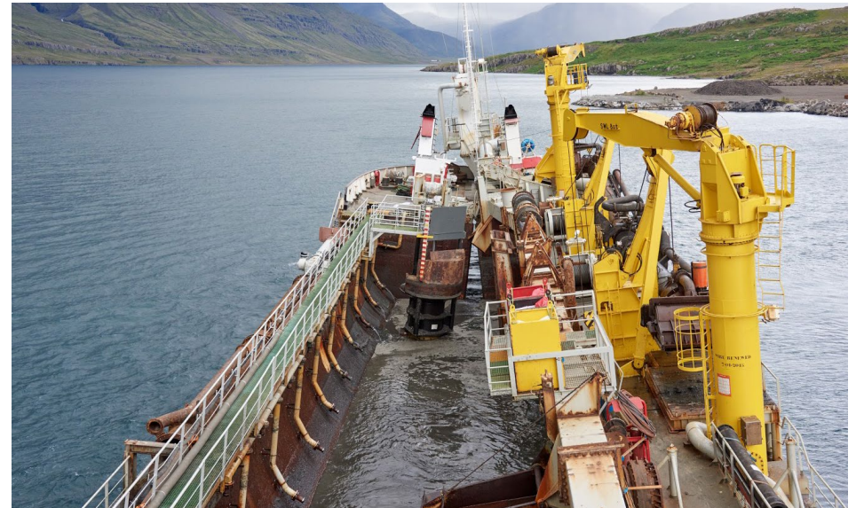
Mynd 1.7 sýnir hvernig botnlúgan er opnuð á Galilei 2000 yfir öðrum stækkunaráfanga Mjóeyrarhafnar og efni sleppt. Þarna sést hvernig skutur skipsins er opnaður.
