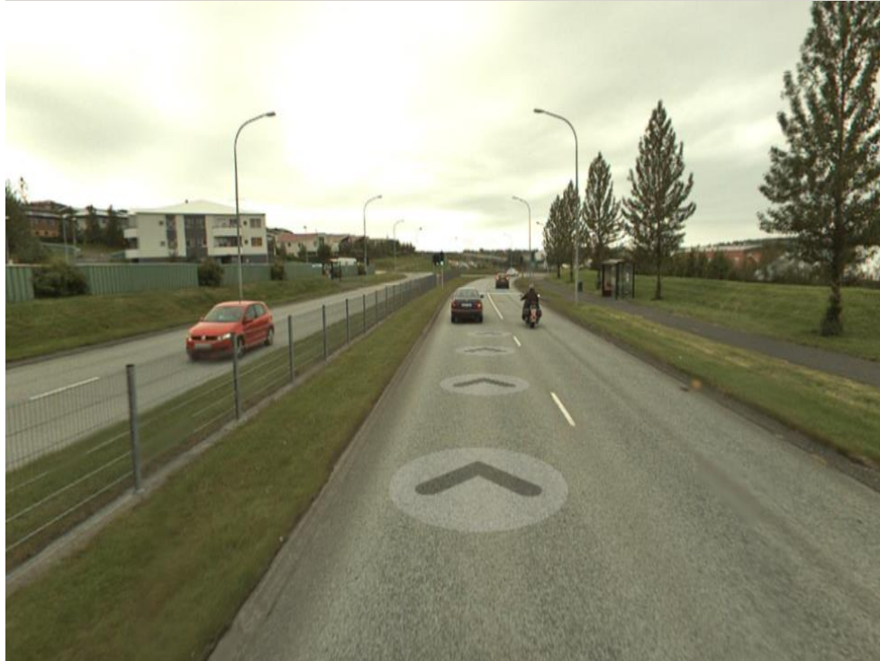
Mynd 4 Á Fífuhvammsvegi væri hægt að nota núverandi göturými til fulls þannig að miðeyja hverfur að mestu og er nýtt í staðinn fyrir hágæðakerfi.
