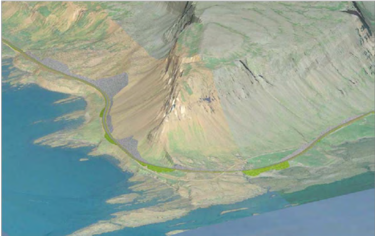
Mynd 6.10.31. Veglína B um Litlanes (svæði VI) og Litlaneshraun (svæði VII). Grænt= fylling, grátt= skering, brúnt yrjótt= landmótunarsvæði (Myndvinnsla Halldór Sv. Hauksson).
