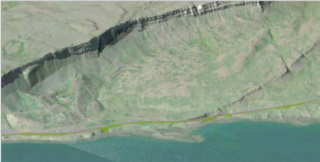
Mynd 6.10.21. Vesturhlíð Kerlingarfjarðar á milli stöðva 4400-6900. Grænt= fylling, grátt= skering, brúnt yriðtt= landmótunarsvæði (Myndvinnsla: Halldór Sv. Hauksson).
