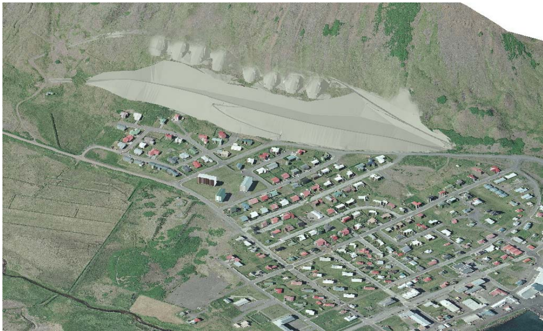
Mynd 12. Snjóflóðagarðurinn settur inn á loftmynd.
