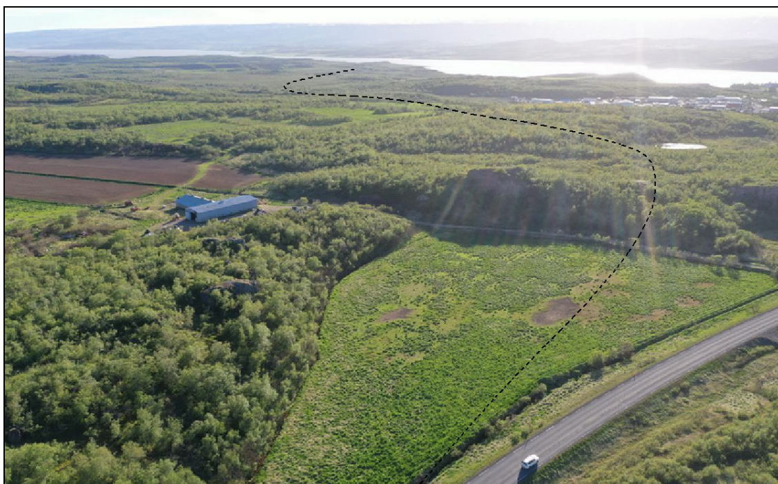
Mynd 2.4.2. Suðurleið sveigir til vesturs um 0,5 km sunnan við þéttbýlið á Egilsstöðum og fer í gegnum klapparás með þykkum berggangi við stöð 300 og áfram suð-vestan við tjörnina í fjarska.
