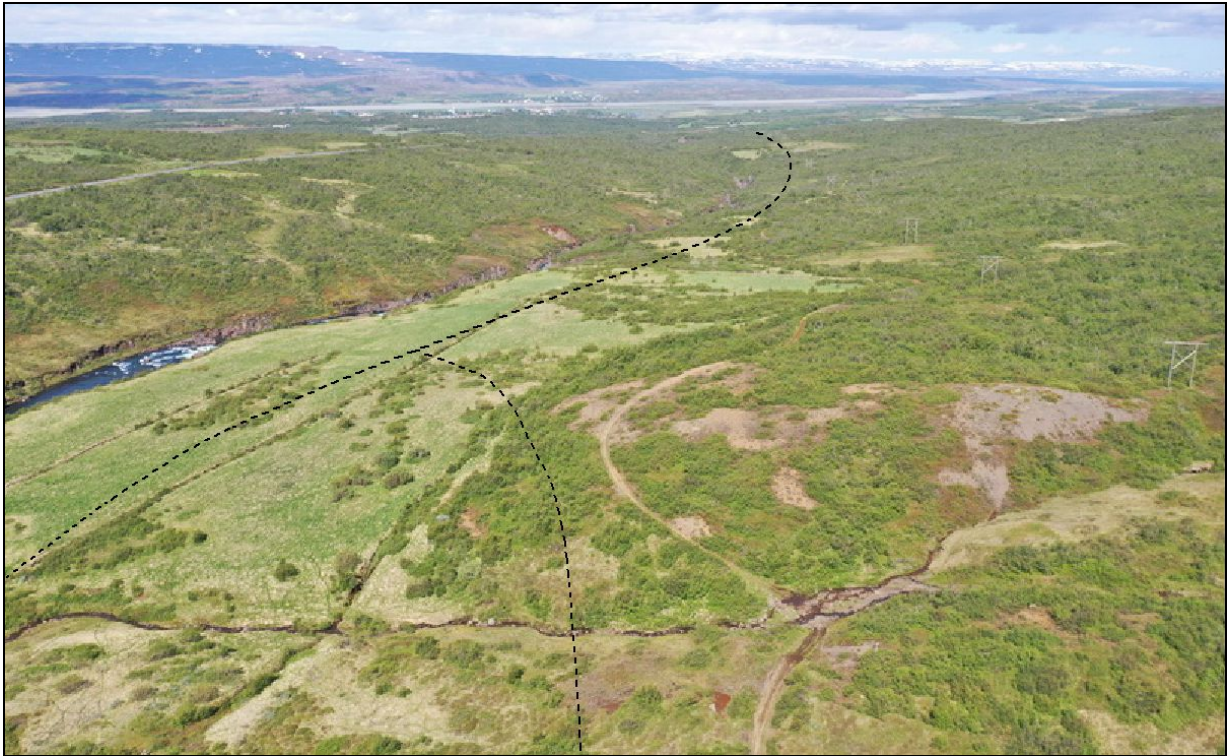
Mynd 2.2.14. Horft norður eftir Norðurleið (nærri stöð 6800). Áformað er að Seyðisfjarðarvegur úr jarðgöngunum tengist inn á Norðurleið til vinstri við melholtið á miðri myndinni.
