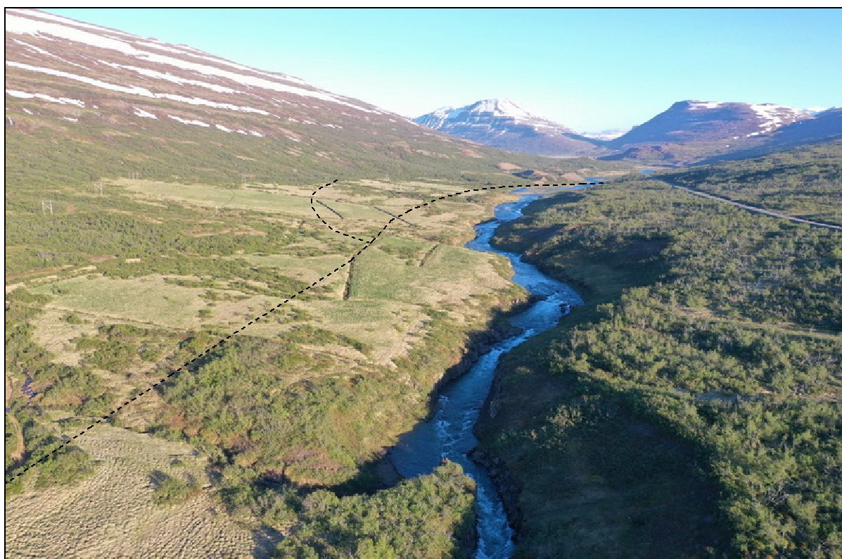
Mynd 2.2.11. Horft suður yfir Eyvindará og vegstæði Norðurleiðar (nærri stöð 6300). Vegamót vegar suður Fagradal og að gangamunna eru áformuð nærri áberandi skurði sem sér eftir til vinstri við ána. Undir túnunum er víða 1-3 m þykk hallamýri. Ef Eyvindará verður þveruð er gert ráð fyrir brú yfir þrengslin í ánni skammt handan við hliðar-gilið til vinstri.
