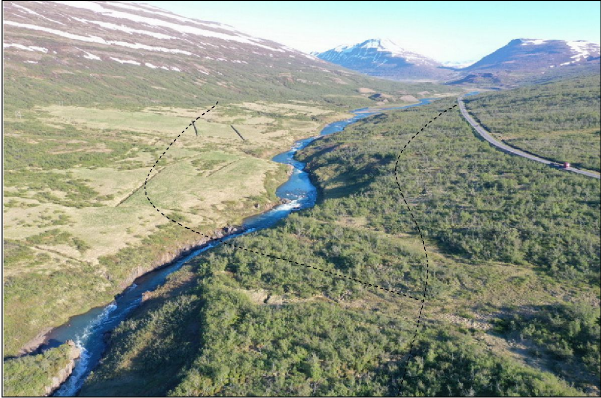
Mynd 2.3.6. Miðleið nærri stöð 1800 og eru vegamót við Seyðisfjarðarveg áætluð við stöð 1950 sem er vestan við trjáþyrpinguna á hringlaga hristorfu, vestan Eyvindarár neðarlega á myndinni. Brúarstæði yfir Eyvindarár er þar sem áin rennur þrengst milli skurðanna í austurbakka hennar. Miðleið tengist svo núverandi Fagradalsbraut fjær á myndinni.
