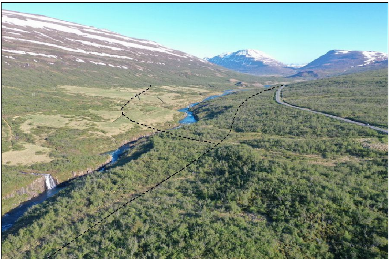
Mynd 2.3.5. Miðleið nærri stöð 1600 þar sem veglínan liggur tæplega 100 m frá gilbrún Eyvindarár.
