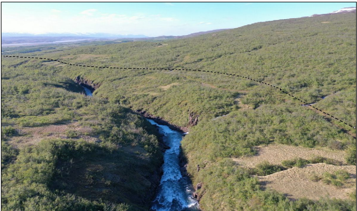
Mynd 2.2.9. Horft út yfir Eyvindará og norður eftir vegstæði Norðurleiðar (nærri stöð 6200) á Eyvindarárdal. Landið er hulið birkiskógi en víða leynast litlar malarfyllur í kjarrinu og á stöku stað eru þunnar hallamýrar á klöppinni.
