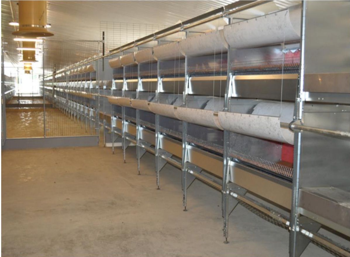
MYND 2.1 Eggjahús með Aviary Pro 10 varpkerfi frá Hellman sambærilegt kerfum sem verða í notkun að Vallá (Heimild Hellmanpoultry.com).
