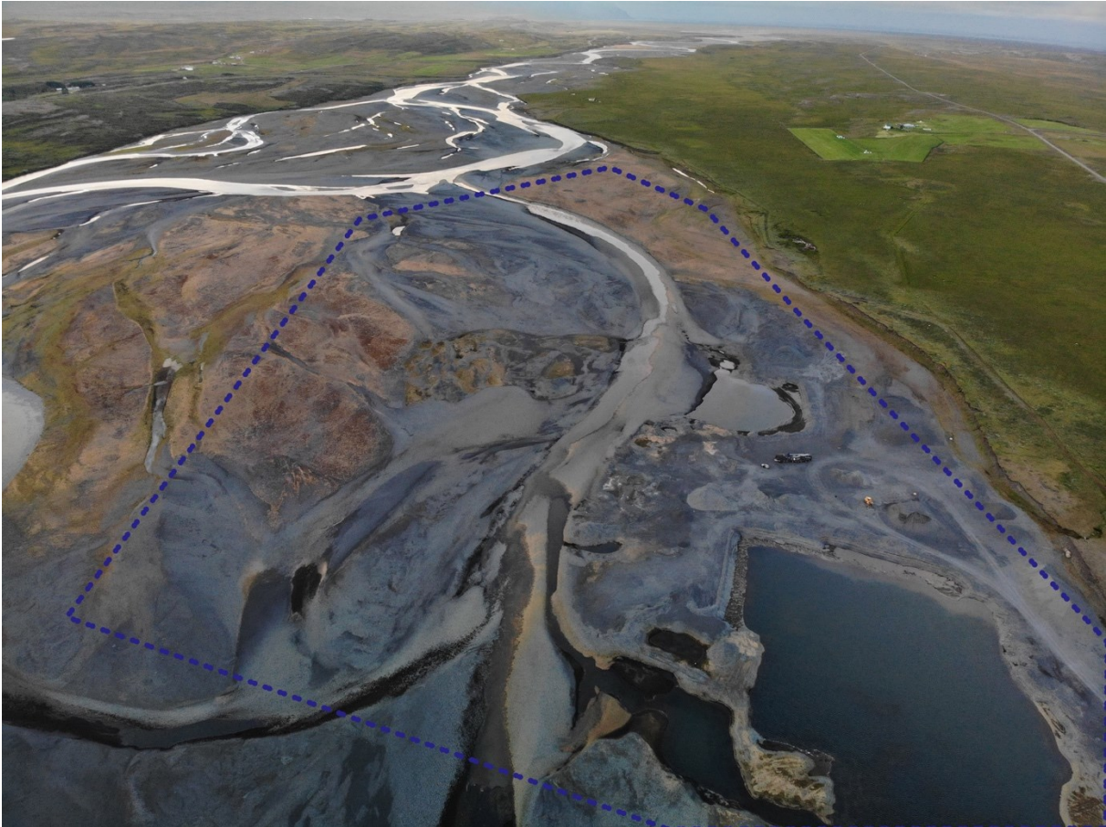
MYND 3.1 Horft yfir fyrirhugað efnistökusvæðis sem er afmarkað með blárrí punktalínu. Núverandi efnistökusvæði sést niðri til hægri. Kvíslin fyrir miðri mynd er þurr stærstan hluta ársins en í vorflóðum og þegar Kárahnjúkastífla fer á yfirfall rennur um hana vatn. Ljósmynd: Skúli Björn.
