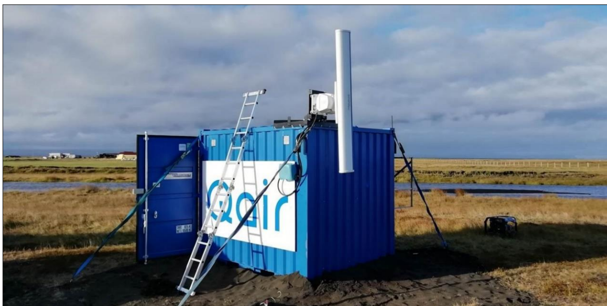
Mynd 5.8 Ratsjá uppsett í lóðréttari stillingu á framkvæmdasvæði.
