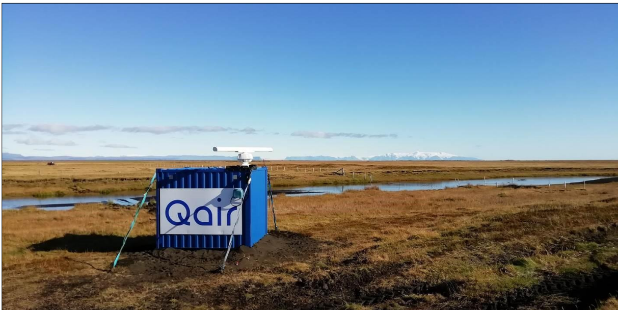
Mynd 5.6 Ratsjá uppsett í láréttri stillingu á fyrirhuguðu framkvæmdasvæði.
