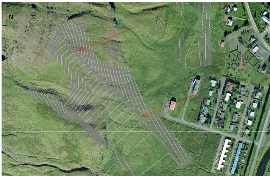
Mynd 20.3 Rauðar örvar sýna ANA átt sem gæti valdið hengjum á flóðhlið Bakkagarðs (Efla, Verkís og Landslag, 2018).
