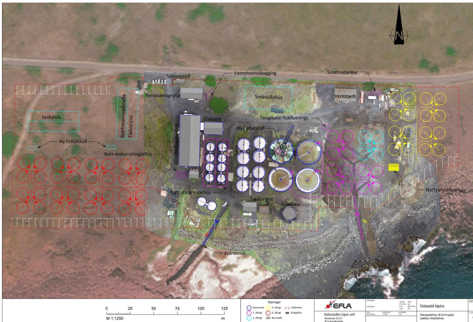
MYND 3-1 Yfirlitsmynd af eldistöð Íspórs í Þorlákshöfn eftir fyrirhugaða stækkun í 1.800 t/ári. Á myndinni er einnig sýnd yfirstandandi stækkun sem rúmast innan núverandi leyfa (1. áfangi). Mynd í betri upplausn má sjá í viðauka A.
