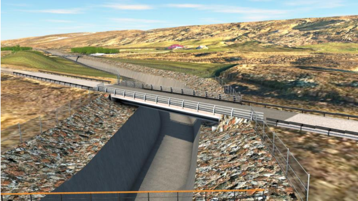
Mynd 4.17 Skýringarmynd af brú á Bárðardalsvegi eystri yfir aðrennslisskurð.
