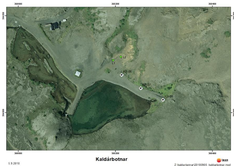
Mynd 5.7 Kort af vatnstökusvæði Vatnsveitu Hafnarfjarðar, sem sýnir staðsetningu sjálfrennslisholanna L1 og L2 og dæluholanna VA, VB og VD (KB-06, KB-07 og KB-08 á mynd). Mynd úr greinargerð ÍSOR-18043
