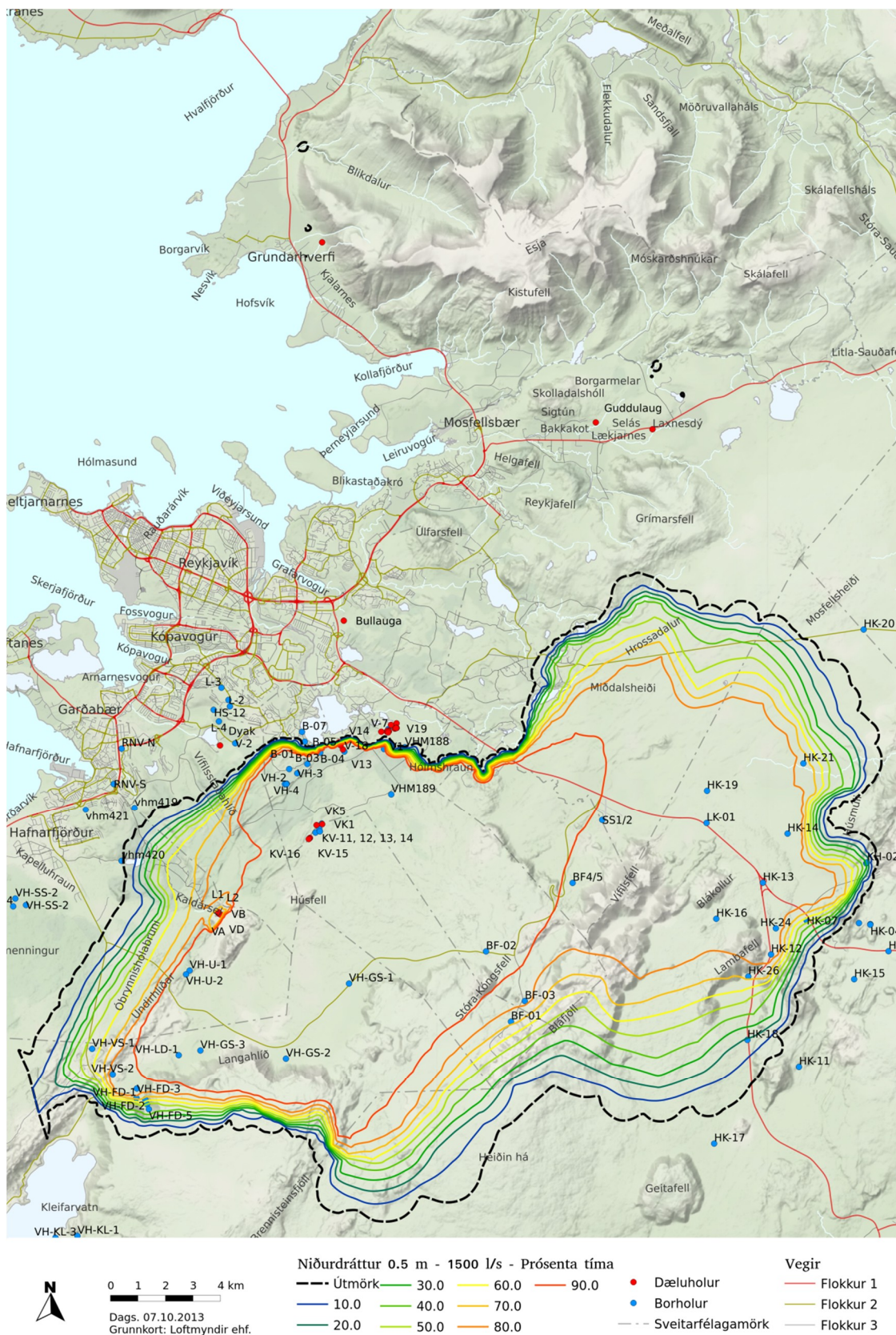
Mynd 11. Reiknaður 0.5 m niðurdráttur við vinnsluaukningu úr 400 l/s í 1500 l/s. Útgildismörk niðurdráttar marka heildarsvæðið þar sem vænta má 0.5 m niðurdráttar. Jafngildislínur sýna prósentu keyrslutíma þar sem 0.5 m niðurdráttur gæti.
