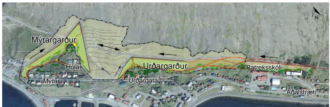
Mynd 5.6 Afstöðumynd vinnuvega á framkvæmdatíma. Aðalvinnuvegir merktir með stórum örnum. Litlar örvir sýna vinnuvegi sem sem verða háðir takmörkunum. Tillögur að legu göngustíga eru rauðmerktar (Landmótun, 2016).
