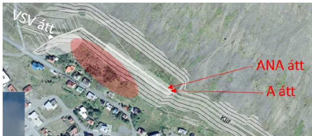
Mynd 10.8 Yfirlitsmynd af líklegum skaflamyndarsvæðum (lituð svæði) við Mýrargarð (Verkís, 2016). Rauðlituð svæði sýnir líklega skaflamyndun í ANA og A átt en hvítitað svæði sýnir líklega skaflamyndun í VSV átt.
