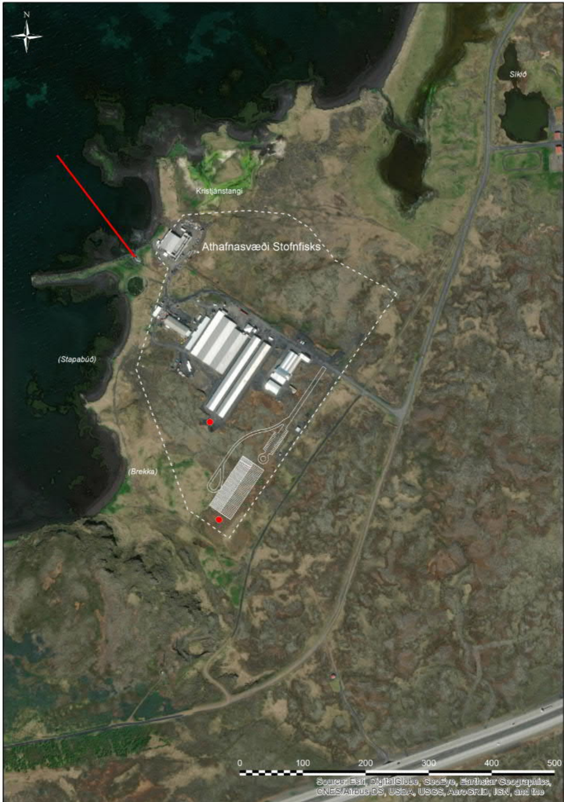
Mynd 4.1 Yfirlitsmynd sem sýnir fyrirhugaða seiðastöð sunnan við hrognahús og afstöðu hennar til annarra mannvirkja á lóð Stofnfisks. Væntanlegar staðsetningar á nýjum borholum fyrir jarðsjó og ferskvatn eru merktar með rauðum depli. Áætluð lega frárennislagnar í sjó er auðkennd með rauðri línu.
