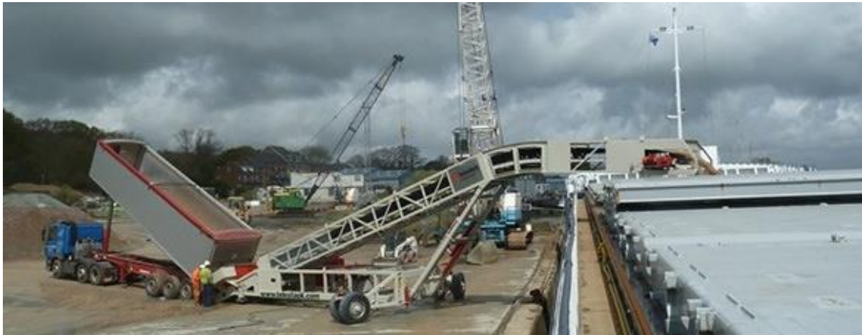
MYND 3.18 Dæmi um notkun á flutningabíl og hleðslufæribandi til að hlaða flutningaskip.
