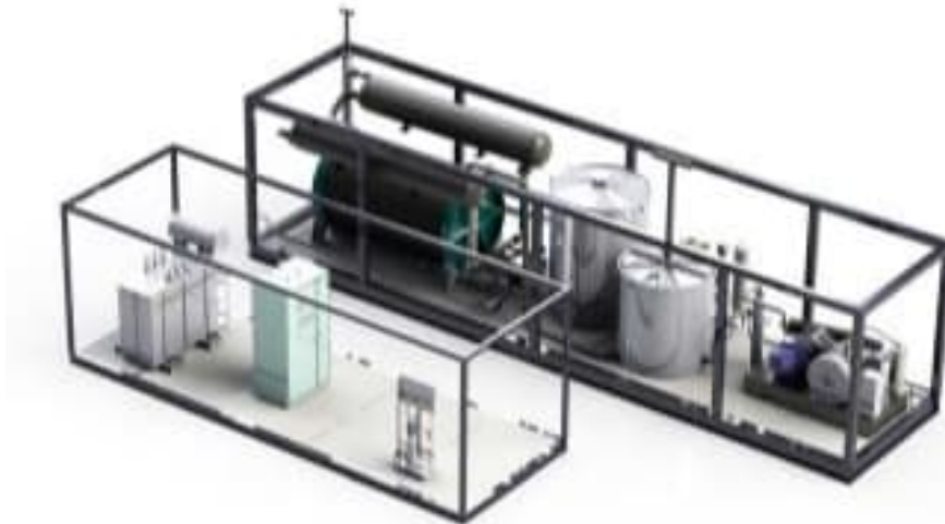
Mynd 2 Vetnisframleiðslustöð eins og sú sem sett hefur verið upp á steypu plani við Hellisheiðarvirkjun.
