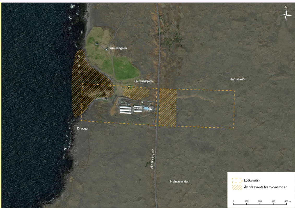
Mynd 8.1 Áhrifasvæði framkvæmdarinnar á lóð BG Iceland og í sjó. Áhrifa hennar mun einnig gæta á grunnvatnsstraum til sjávar undir lóðinni. Innan svæðisins austan Nesvegur verða boraðar tvær vinnsluholur, þ.e. rask á yfirborði mun gæta á takmörkuðum hluta svæðisins sem sýnt er.
