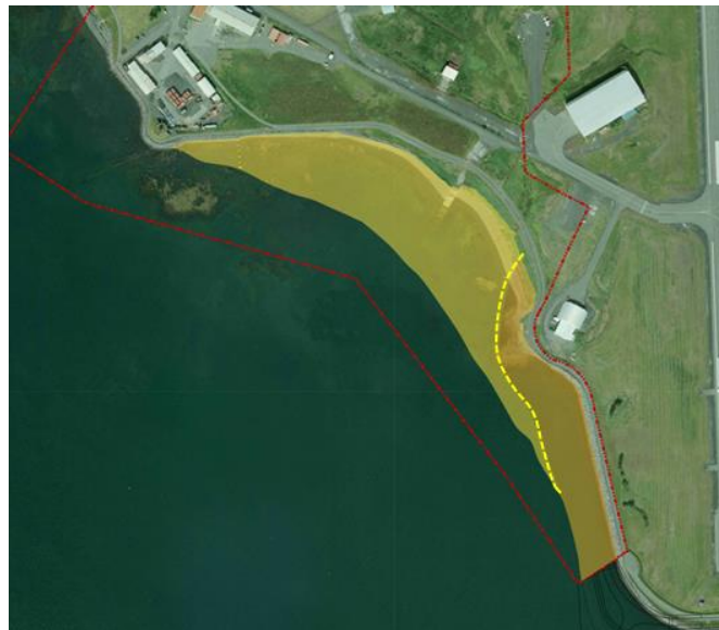
MYND 5.22 Fyrirhuguð landfylling. Austan megin við gulu brotalínuna er sá hluti sem til kemur vegna brúar yfir Fossvog, stofnlagna og almenningsgangna. Vestan megin við gulu brotalínuna er landfyllingin sem umhverfismatið nær til.
